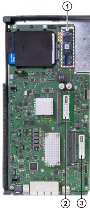
图 10-96: 内存和内部 SSD 存储器
