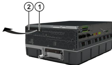
图 10-38: 打开 SSD 插槽
