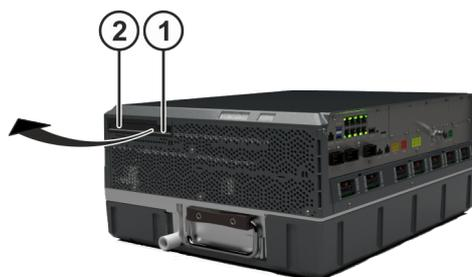
图 10-68: 打开 SSD 插槽
