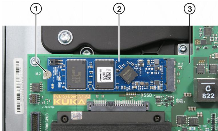
图 10-105: 内部 SSD 存储器
