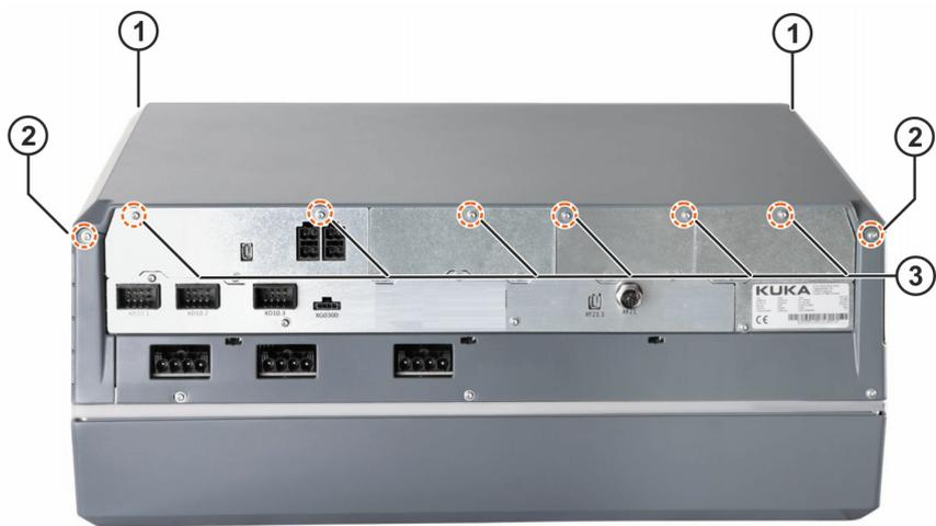
图 10-132: 外壳罩盖上的螺栓
