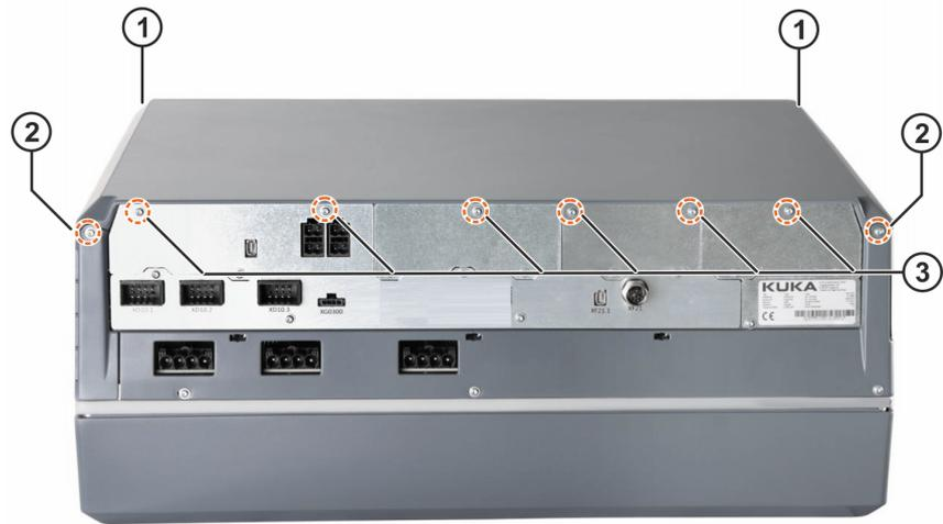
图 10-135: 外壳罩盖上的螺栓
