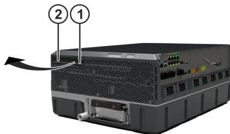
图 10-10: 打开 SSD 插槽
