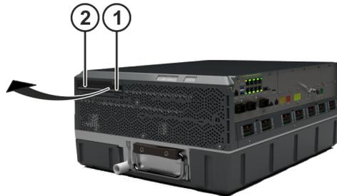
图 10-116: 打开 SSD 插槽
